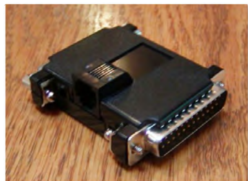
GPUSB og GPINT-PT fra Shoestring Astronomy. Bruges hvis guidekameraet ikke har en udgang til monteringsens guideport
